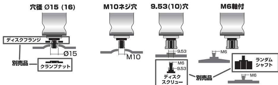
M6軸付 { マジックパッド (外径 Ø50・75)
